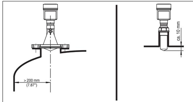
Abb. 1: Abstände der Antenne zu Behälterwand/Behälterdecke
