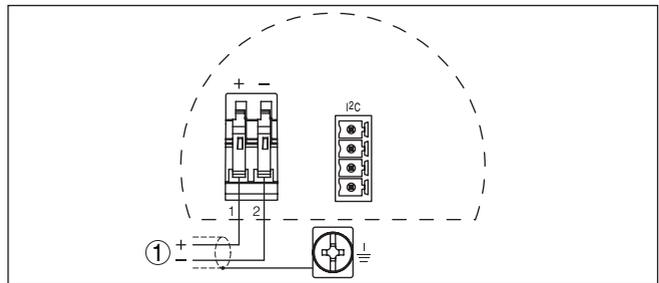
Abb. 4: Anschlussplan - Zweikammergehäuse
