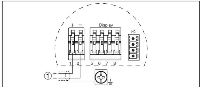
Abb. 3: Anschlussplan - Einkammergehäuse
