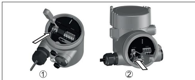
Figura 5: Operazioni di collegamento 5 e 6
