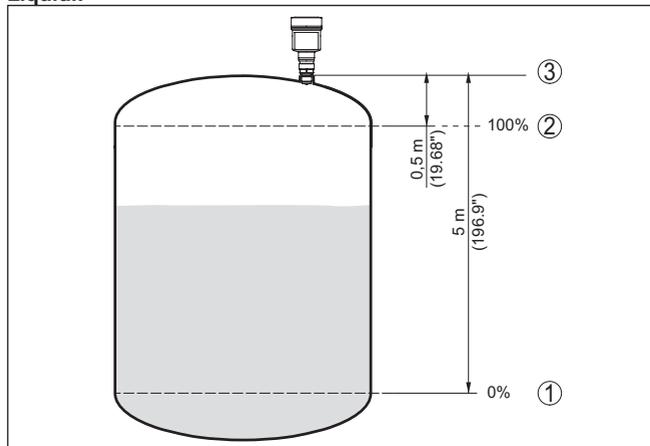
Figura 9: Esempio di parametrizzazione taratura di min./max. - Liquidi
