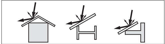
Abb. 13: Glatte Profile mit Streublenden abdecken
