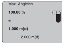
1. Mit **[OK]** den Prozentwert zum Editieren vorbereiten, und den Cursor mit **[->]** auf die gewünschte Stelle setzen. Den gewünschten Prozentwert mit **[+]** einstellen und mit **[OK]** speichern. Der Cursor springt nun auf den Distanzwert.
