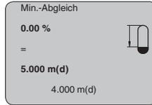
3. Mit **[OK]** den Prozentwert zum Editieren vorbereiten, und den Cursor mit **[->]** auf die gewünschte Stelle setzen. Den gewünschten Prozentwert mit **[+]** einstellen und mit **[OK]** speichern. Der Cursor springt nun auf den Distanzwert.
