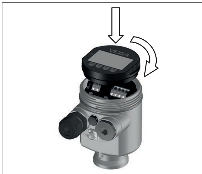
Fig. 27: Montage du module d'affichage et de réglage dans le boîtier à chambre unique se trouvant dans le compartiment de l'électronique
