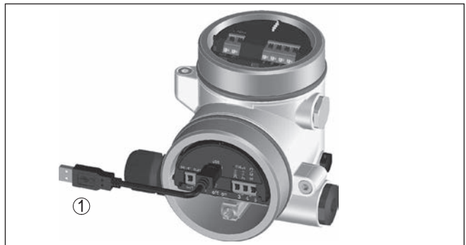
Figura 33: Collegamento del PC all'elettronica Modbus via USB
