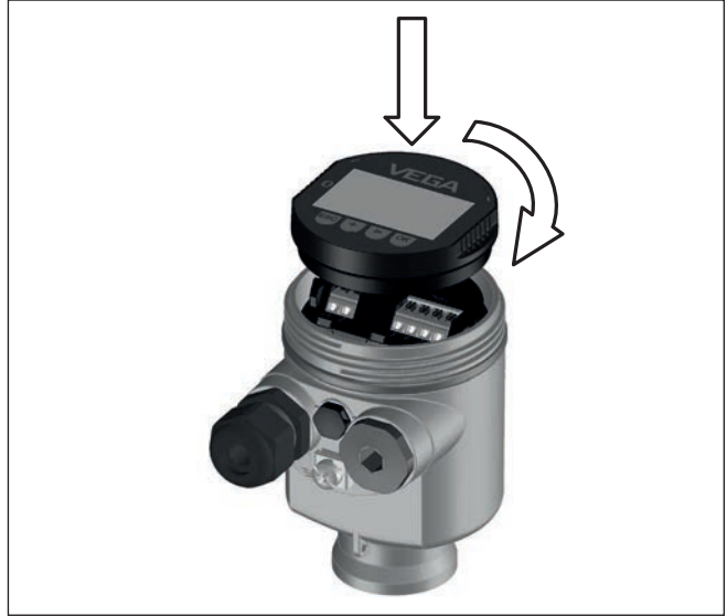
Res. 25: Elektronik bölümünde bir hücreli gövdede gösterge ve ayar modülünün çalıştırılması
