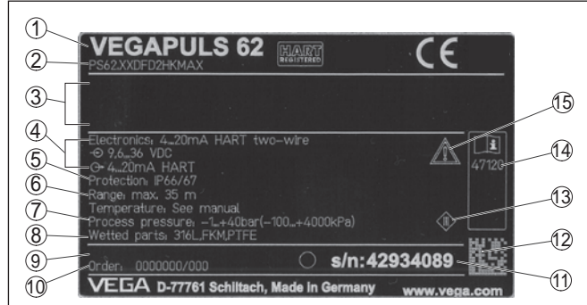
Fig. 1: Présentation de la plaque signalétique (exemple)
