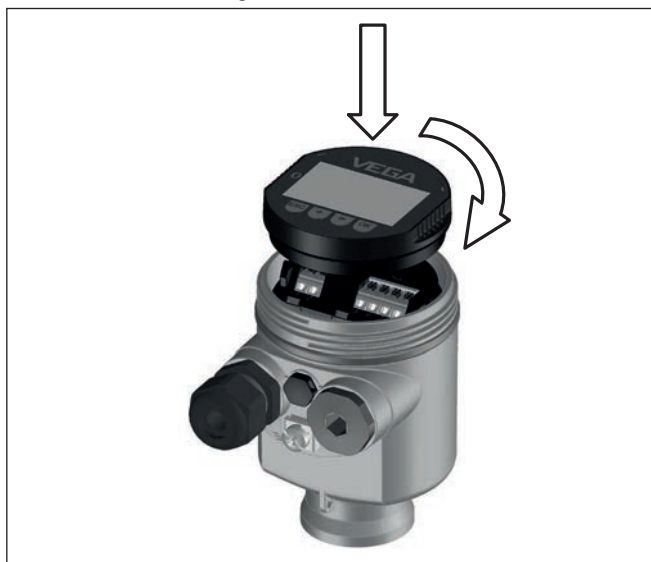
Figura 25: Inserimento del tastierino di taratura con display nel vano dell'elettronica in caso di custodia ad una camera
