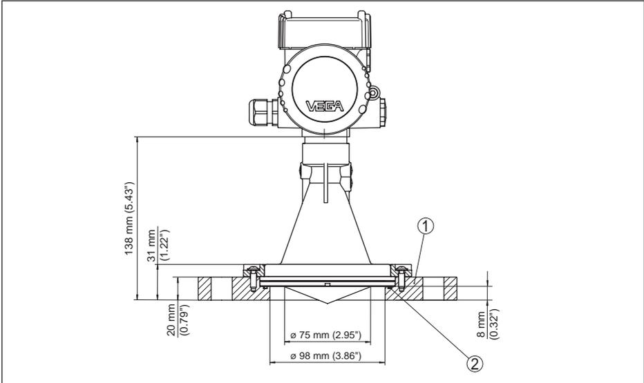
Fig. 54: VEGAPULS 61, brida de adaptación
