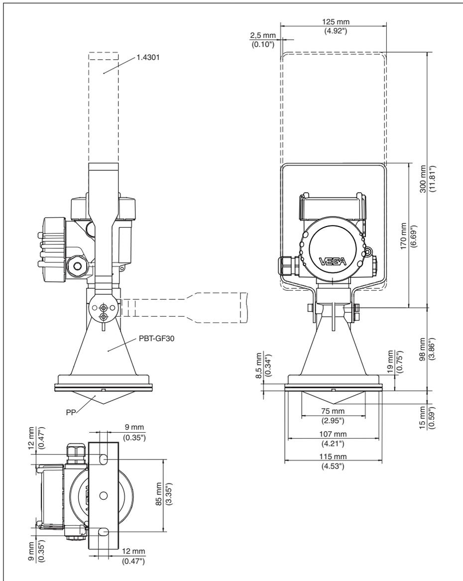
Fig. 51: VEGAPULS 61, estribo de montaje largo 170 o 300 mm
