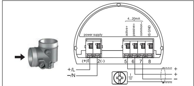
Fig. 22: Compartimiento de conexiones carcasa de dos cámaras con bajo voltaje
