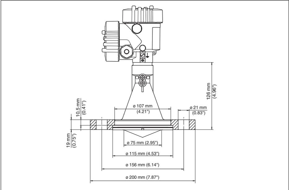
Fig. 52: VEGAPULS 61, brida suelta adecuada para DN 80 PN 16, ASME 3" 150lbs, JIS80 10K
