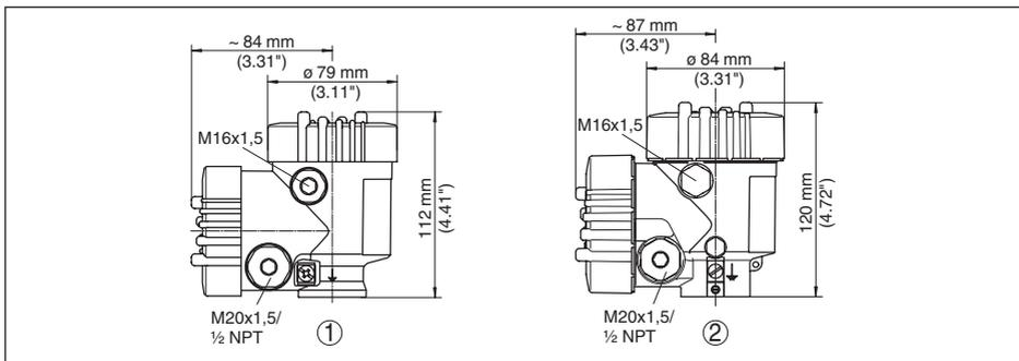
Fig. 50: Medidas de la carcasa ((con el módulo de visualización y configuración montado aumenta la altura de la carcasa en 9 mm/0.35 in, con carcasas de metal en 18 mm/0.71 in)
