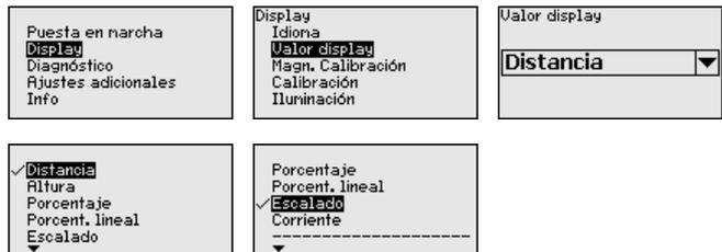
El ajuste por defecto para el valor indicado es p. Ej. distancia para sensores de radar.
