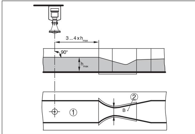
Fig. 18: Medición de caudal con canal venturi Khafagi:  $h_{max}$  = llenado máx. del canal; B = mayor estrechamiento del canal
