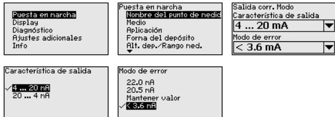
El ajuste por defecto es la curva característica de salida 4 ... 20 mA, del modo de fallo < 3,6 mA.
