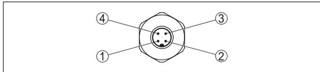
Fig. 24: Vista del conector de enchufe M12 x 1
