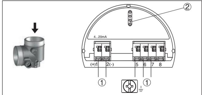
Fig. 20: Compartimiento de la electrónica - Carcasa de dos cámaras.
