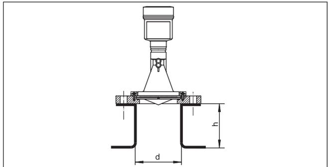
Las tablas a continuación reflejan la longitud máxima de tubuladura  $h$  en dependencia del diámetro  $d$ .
