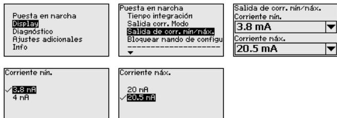
El ajuste por defecto es corriente mín. 3,8 mA y corriente máx. 20,5 mA.
