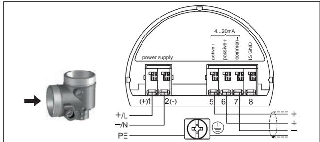
Fig. 21: Compartimiento de conexiones carcasa de dos cámaras con tensión de red
