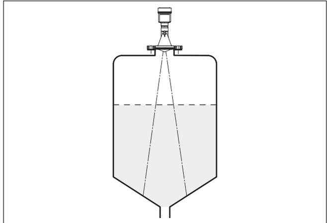
Fig. 7: Montaje del sensor de radar en depósito con fondo cónico
