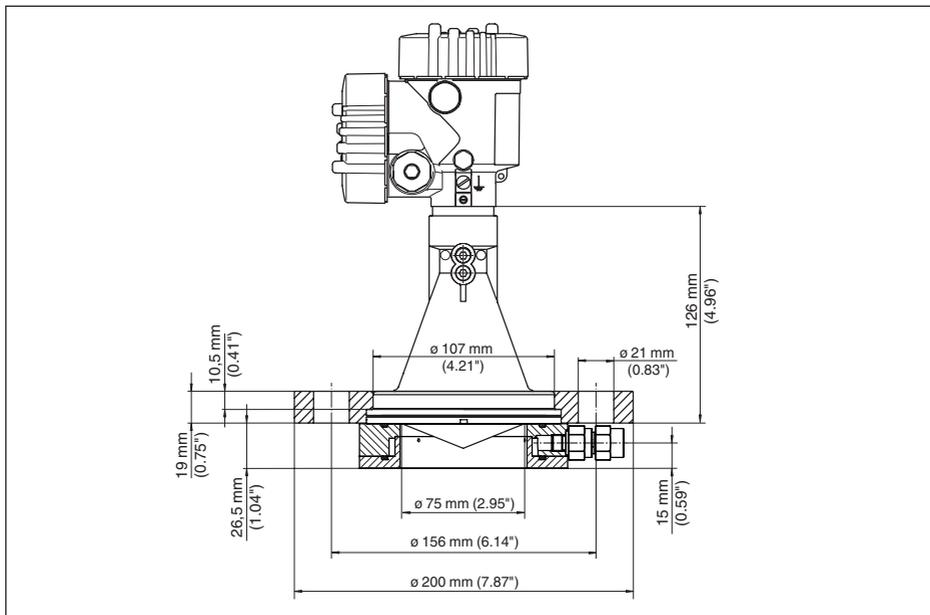
*Fig. 53: VEGAPULS 61, brida suelta con aire de barrido, válida para DN 80 PN 16, ASME 3" 150lbs, JIS80 10K*
