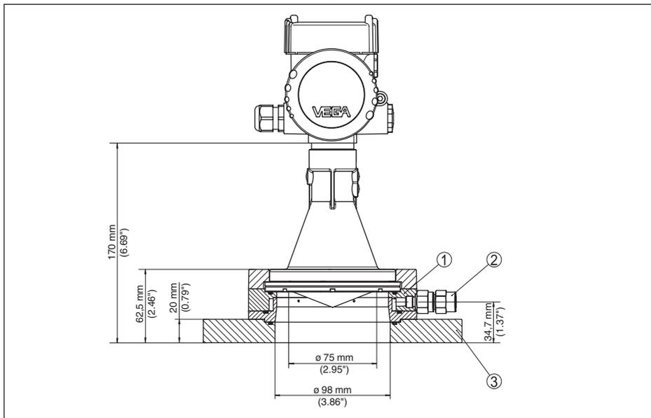
Fig. 55: VEGAPULS 61, brida de adaptación
