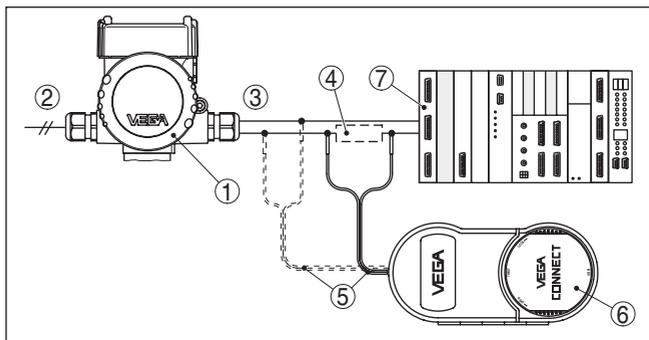
Fig. 31: Conexión del PC a la línea de señal vía HART
