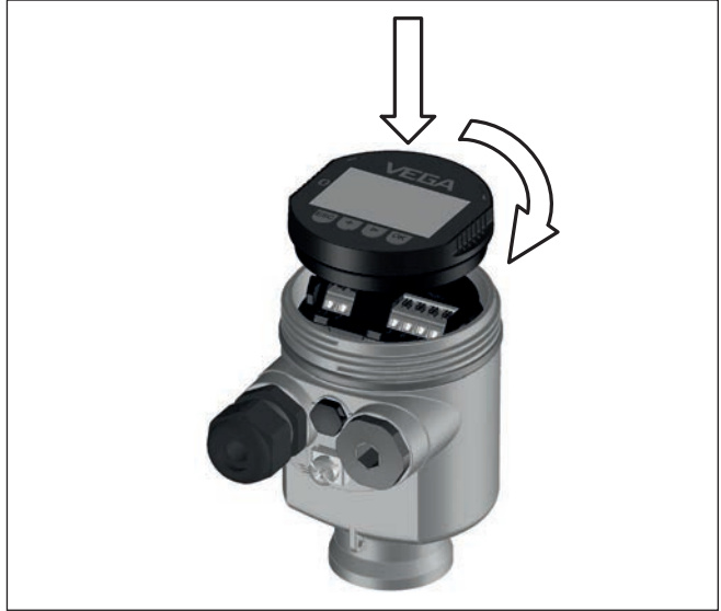
Res. 30: Elektronik bölümünde bir hücreli gövdede gösterge ve ayar modülünün çalıştırılması
