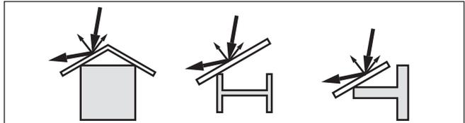
Fig. 12: Recouvrir les obstacles lisses par des déflecteurs
