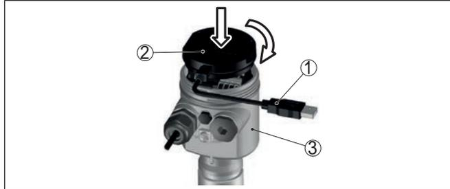
Fig. 35: Raccordement du PC directement au capteur via l'adaptateur d'inter-
