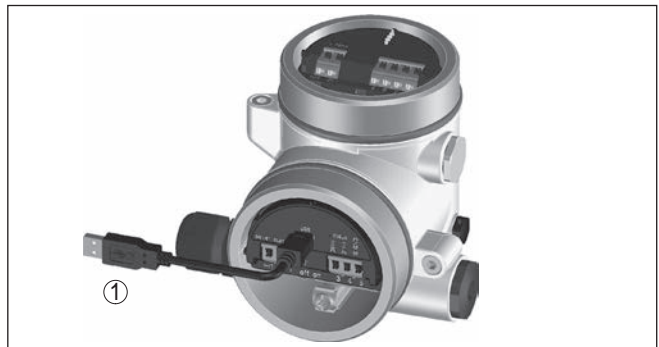
Figura 30: Collegamento del PC all'elettronica Modbus via USB
