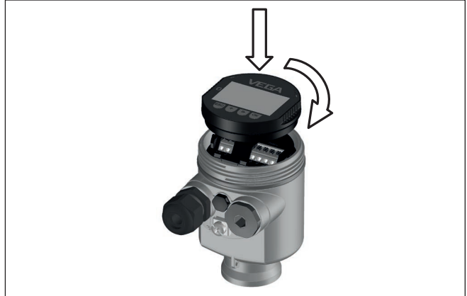
Res. 8: Elektronik bölümünde bir hücreli gövdede gösterge ve ayar modülünün çalıştırılması
