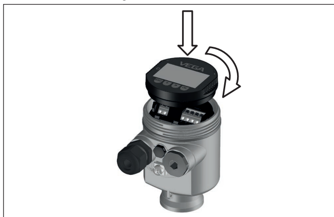
Figura 8: Inserimento del tastierino di taratura con display nel vano dell'elettronica in caso di custodia ad una camera
