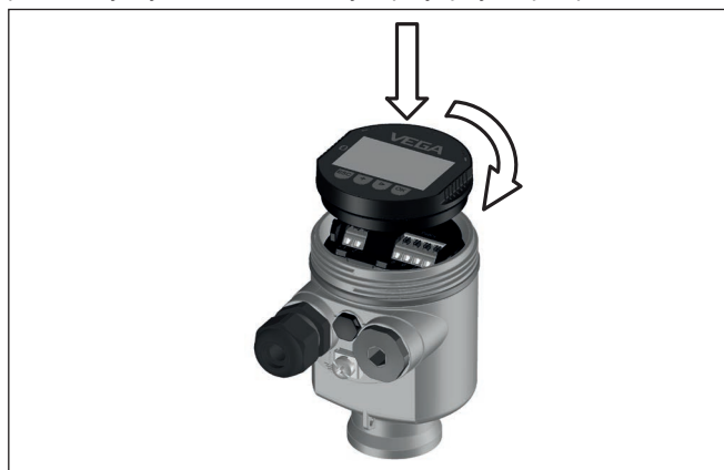
Rys. 8: Wkładanie modułu wyświetlającego i obsługowego do komory układu elektronicznego w obudowie jednokomorowej
