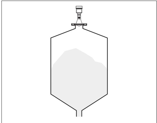
Fig. 2: Montagem do sensor de radar em flange
