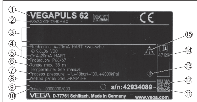
Fig. 1: Présentation de la plaque signalétique (exemple)
