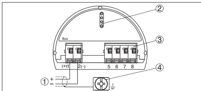
Figura 8: Vano di allacciamento - custodia a due camere
