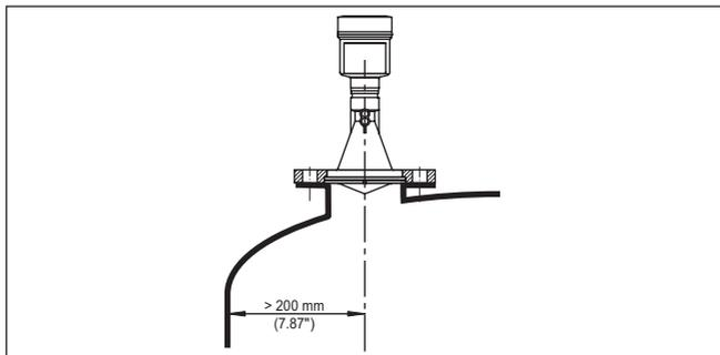
Figura 5: Distanze dell'antenna dalla parete/dal cielo del serbatoio
