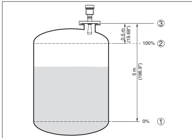
Figura 11: Esempio di parametrizzazione Taratura di min./max.
