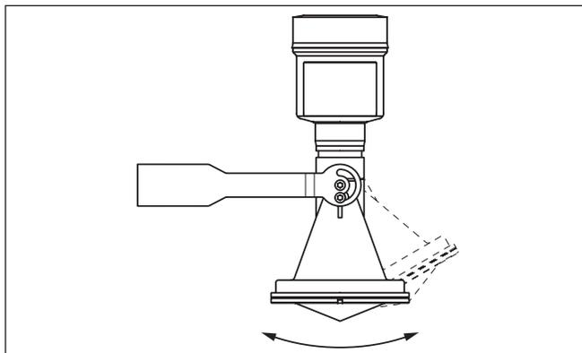
Figura 3: Regolazione dell'angolo d'inclinazione
