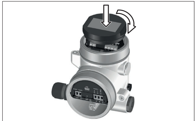
Fig. 10: Insertion du module de réglage et d'affichage
