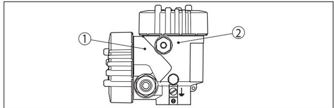
Figura 7: Posizione del vano di connessione (elettronica Modbus) e del vano dell'elettronica (elettronica sensore)
