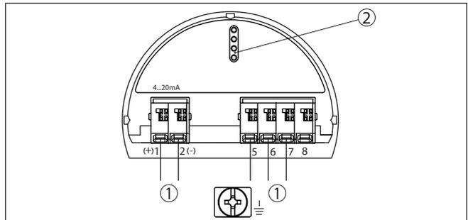
Figura 8: Vano dell'elettronica - custodia a due camere
