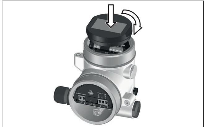
Fig. 10: Colocação do módulo de visualização e configuração
