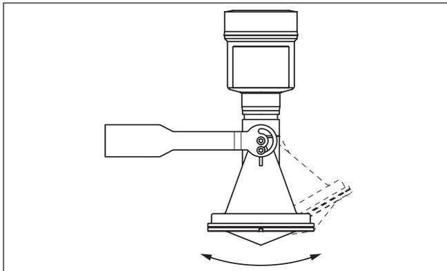
Fig. 3: Ajuste do ângulo de inclinação
