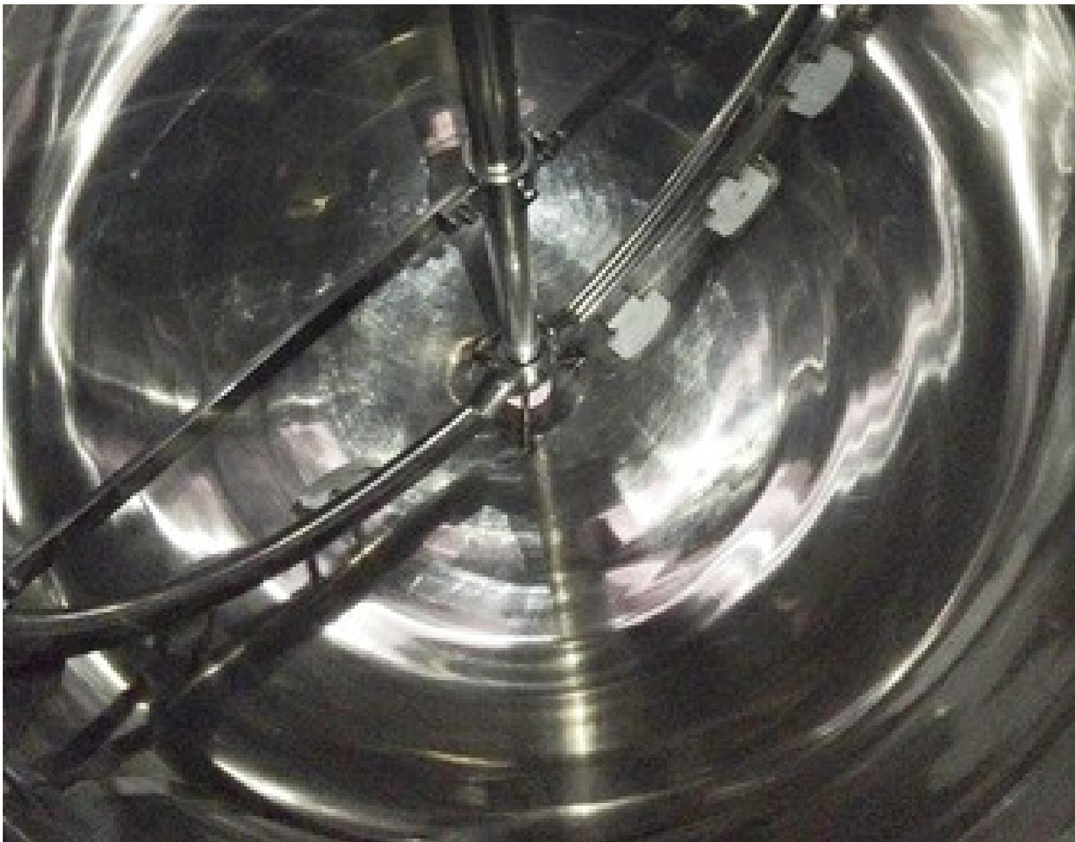
Pendant le fonctionnement, les racleurs éliminent en permanence les dépôts sur l'enveloppe chauffante de la cuve : le faisceau focalisé du VEGAPULS 64 mesure le niveau sans problème en évitant les palettes.
