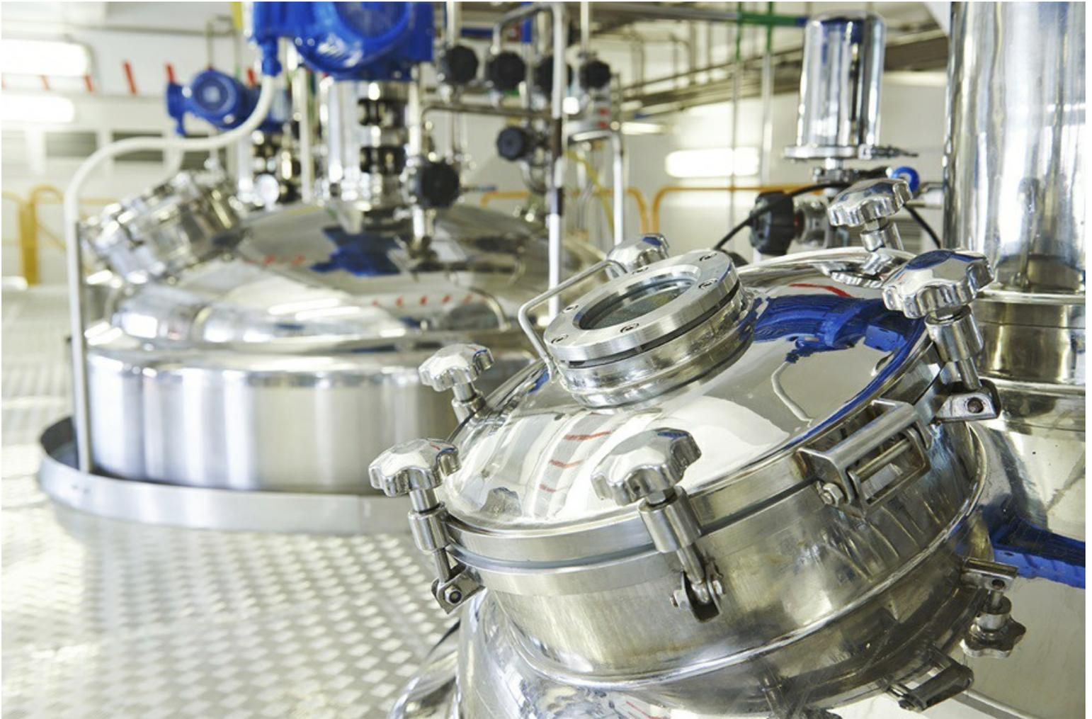
L'ottima focalizzazione del segnale del VEGAPULS 64 rende possibile una misura affidabile anche attraverso finestrelle di piccole dimensioni.
