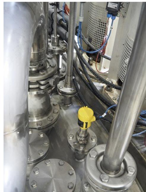
El instrumento de medición de nivel radar VEGAPULS 64 mide el nivel de forma fiable en las plantas de producción.
