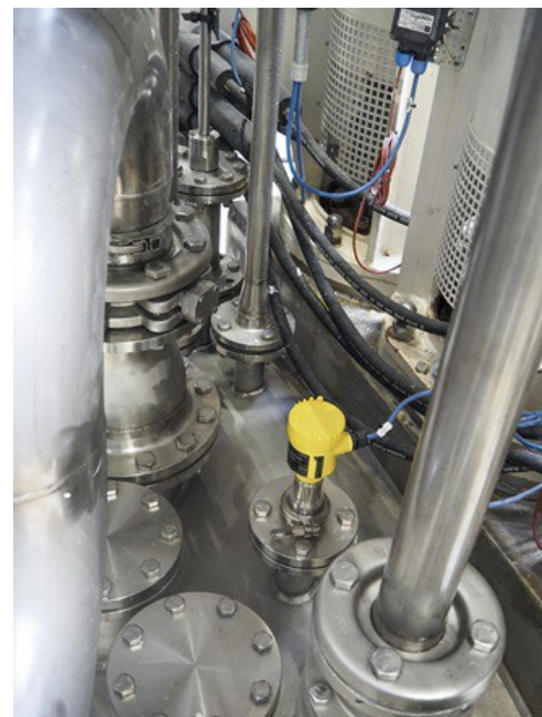
VEGAPULS 64 型雷达液位测量仪能可靠地测量生产设备中的液位。
