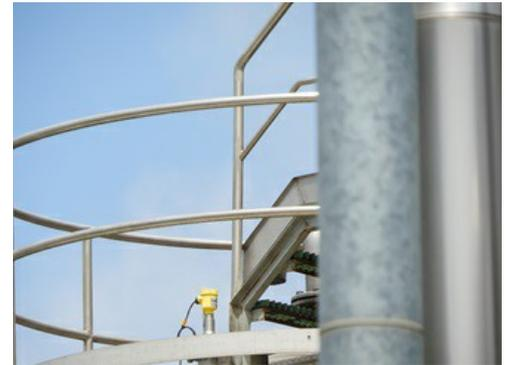
Mit dem Einbau des VEGAPULS 64 konnten die Messunsicherheiten gelöst werden. Der Sensor wurde dafür einfach auf den vorhandenen Stützen aufgesetzt.
