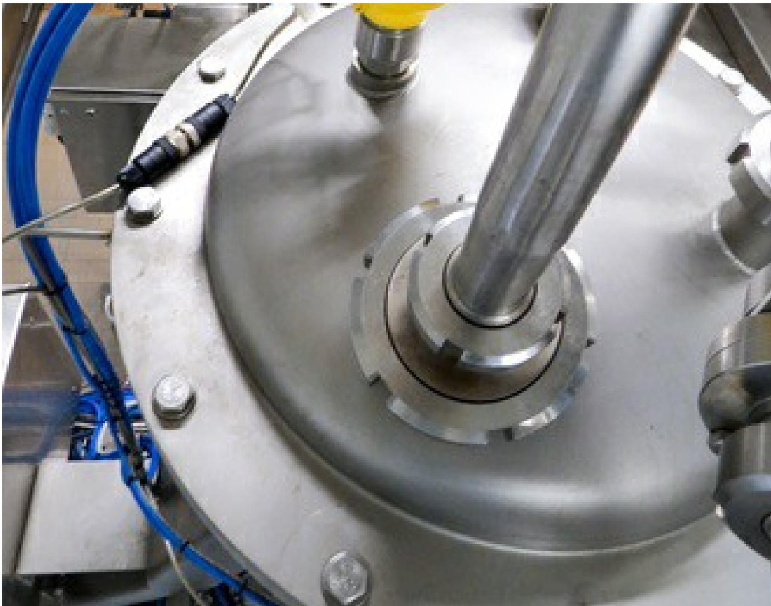
Des capteurs VEGA contrôlent le niveau de remplissage afin que le conditionnement des yaourts se déroule sans accroc.
