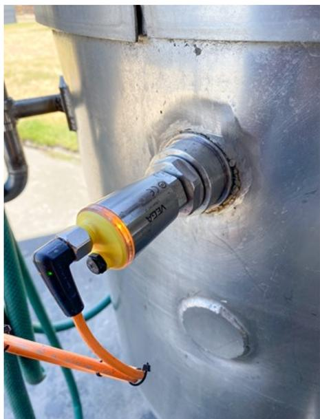
VEGA avait développé un nouveau détecteur de niveau capacitif très prometteur mais il n'était pas encore mis sur le marché à l'époque. L'entreprise a proposé de tester l'appareil avant son lancement officiel. Le **VEGAPOINT 21** est un détecteur de niveau capacitif pour la détection des liquides aqueux. Le capteur et la cuve constituent les deux électrodes d'un condensateur. La variation de niveau provoque une variation de la capacité qui est convertie en signal de commutation.
