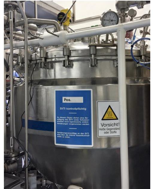
VEGAPULS 64 型雷达传感器的波长极短，能够在整个生产过程中实现高精度的液位检测。
