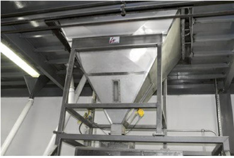
On peut désormais mesurer avec fiabilité le remplissage du réservoir de croquettes et le maintenir à un niveau constant.
