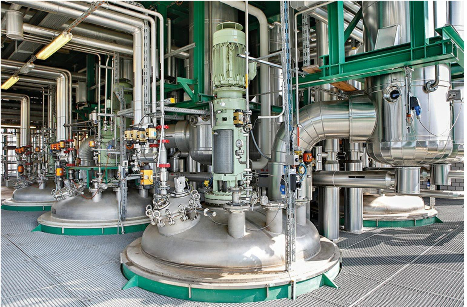
Selbst bei massiven Rührwerken mit stark bewegter Füllgutoberfläche erfassen 80 GHz-Radarsensoren sicher den Füllstand.
