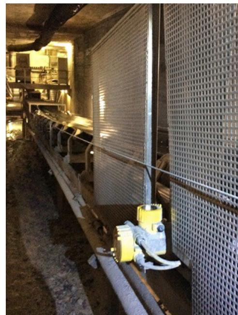
Il WEIGHTRAC 31 può essere montato anche su nastri trasportatori preesistenti. Poiché la misura avviene senza contatto, non ci sono problemi di usura.
