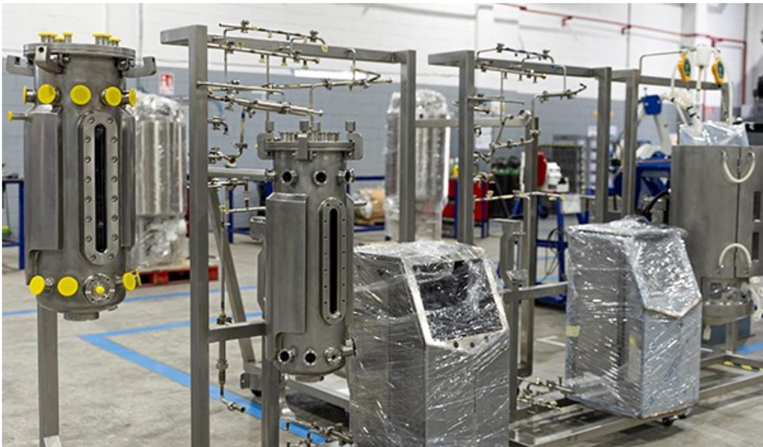
Les installations sont équipées de différents capteurs VEGA. Ils envoient leurs signaux analogiques et numériques 4 ... 20 mA au logiciel eSCADA développé par TECNIC. Ce système s'appuie sur la plateforme AVEVA et gère les paramètres de pilotage ainsi que la réalisation des recettes conformément aux normes GAMP5 et CFR21. « Nous mettons nous-mêmes les capteurs en service. Mais nous savons que nous pouvons toujours compter sur l'assistance technique de VEGA », constate Manel Estany.
