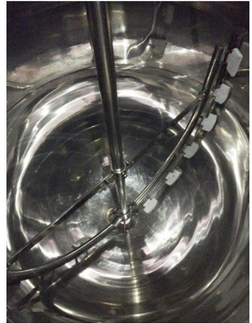
Während des Betriebs halten Schaber den Heizmantel des Behälters kontinuierlich von Anhaftungen frei: Der fokussierte Strahl des VEGAPULS 64 misst problemlos daran vorbei.
