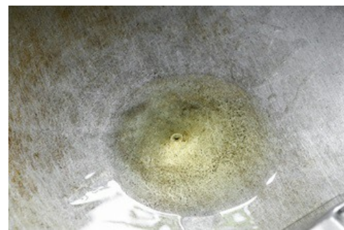
Olie op de tankbodem. Bij lage niveaus is het erg moeilijk olie of andere vloeistoffen exact te meten.
