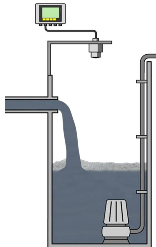
L'excellente focalisation du signal du VEGAPULS permet une détection fiable de la surface du produit, même dans les cuves comportant de nombreuses obstacles internes.
