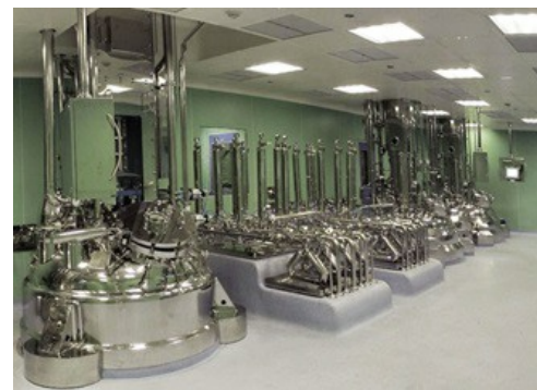
Füllstandsensoren kontrollieren und steuern die unterschiedlichsten Produktmengen.
