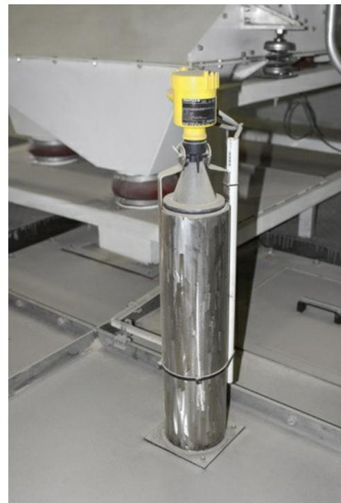
A pesar de que la longitud de onda del VEGAPULS 69 es mucho más corta, este sensor radar no se ve afectado por las adherencias.
