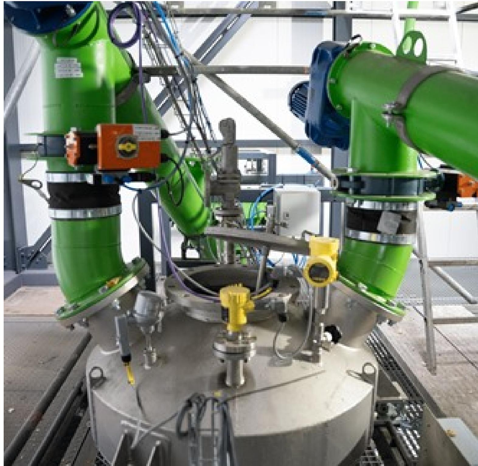
Los sensores de VEGA monitorizan los niveles exactos de presión y nivel durante todo el proceso.
