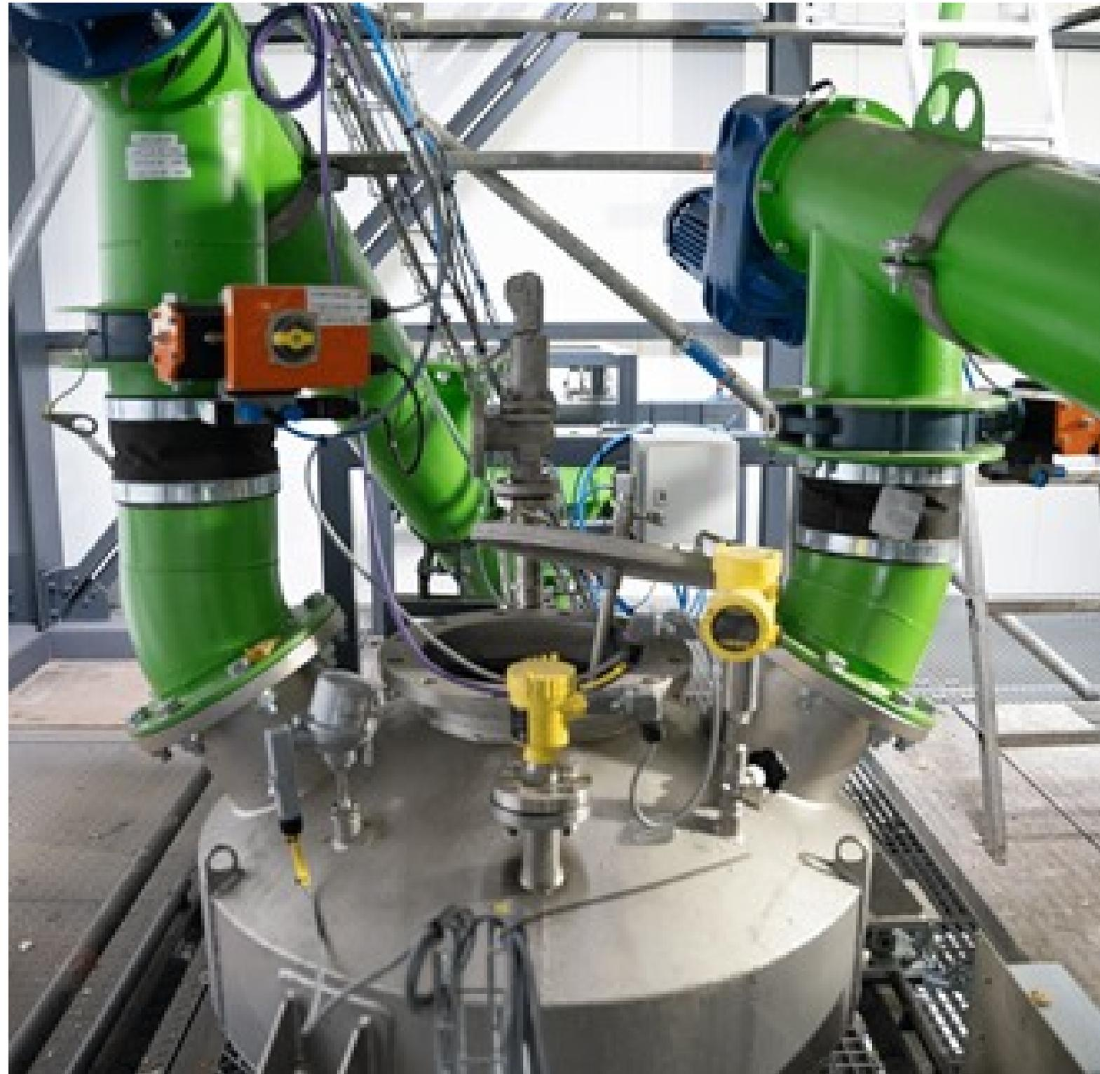
VEGA-Sensoren überwachen im gesamten Prozess die exakten Druck- und Füllstandniveaus.
