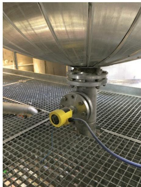
Capteur maître d'un système de mesure de pression différentielle électronique dans une cuve de distillation.
