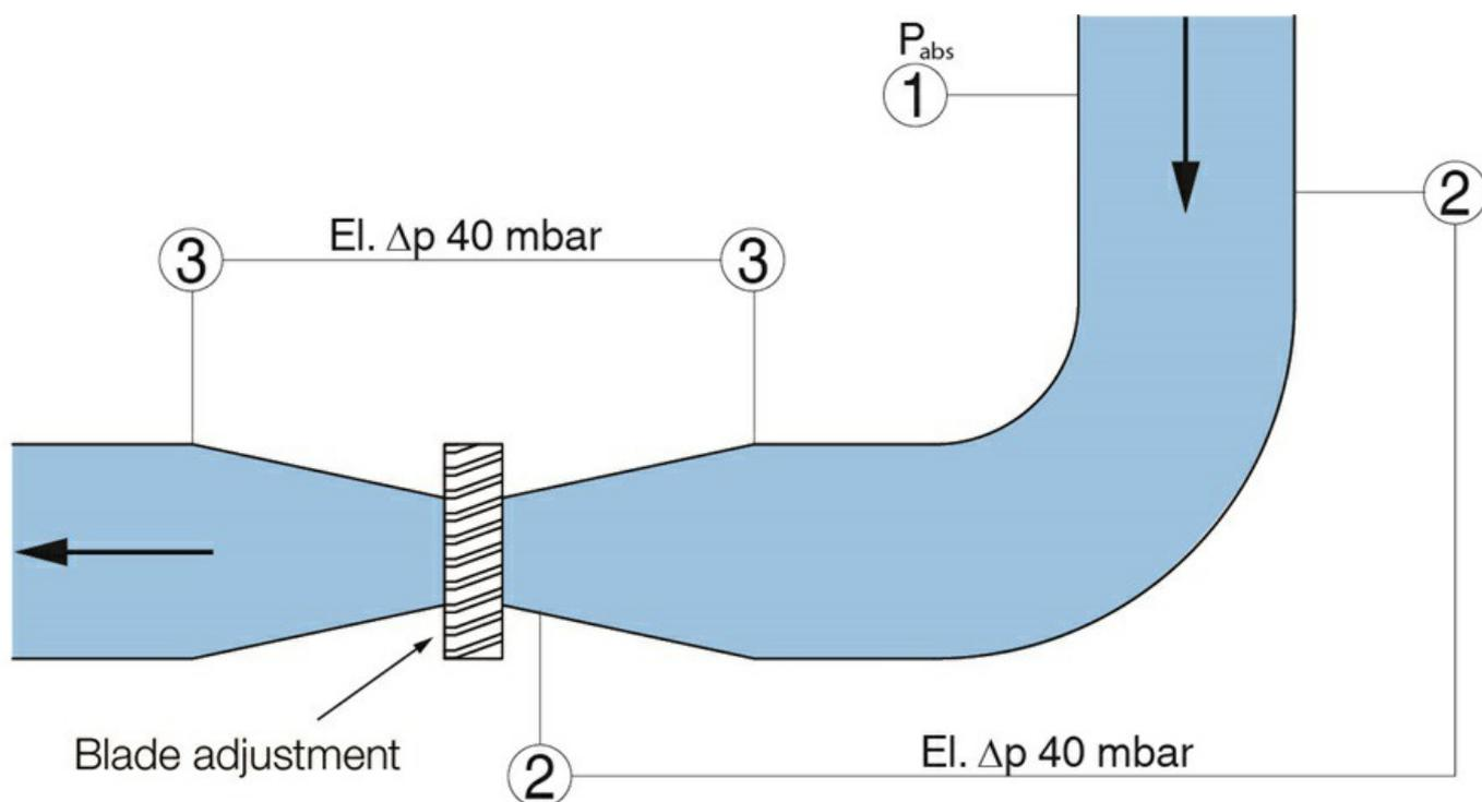
Mesure de pression différentielle électronique sur un ventilateur de tirage dans une centrale à charbon.
