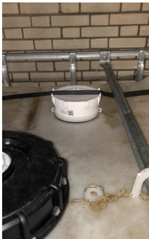
直到数月后，研发才取得了进展：DS Smith De Hoop B.V. 是第一个将 VEGAPULS Air 23 用于监测 IBC 吨桶液位的用户。VEGA 的这些液位计采用自主供电、无线连接，它价格低廉、灵活、安全，还可以通过即插即用的方式实现快速安装。在研发中，仪表的节能是重中之重。为此，研发人员对测量性能、无线数据传输和能耗这三个方面进行了理想的协调和组合。其能源由电池提供，与经优化的测量周期相结合后，可以确保长达 10 年的使用寿命。因此，无论是需要测量哪一处液位，在各种不同的场合都可以放心地使用这些液位计。而且，由于可以采用胶黏式适配器或灵活的绑带安装，它们极易被安装到 IBC 上。
