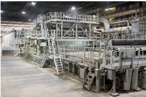
不过，在过去的几十年里，回收纸品的基本生产过程几乎没有改变。在热水和电力的帮助下，废纸捆包在四个碎浆机之一中分解成纸浆。首先，要从纸浆中去除所有杂质。而后干净的纸纤维进入两台造纸机之一，在那里以 50 km/h 的速度被加工成新纸。客户就是用这些纸制作纸箱和托盘。这种纸还可用于石膏板的外表面或门的内表面。
