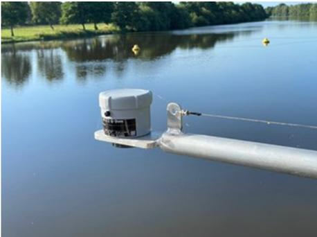
A primera vista, la medición del nivel de agua en ríos y lagos no parece ser un titular que llame mucho la atención a los usuarios de la tecnología de medición. Sin embargo, la exitosa fase de prueba de tres sensores radar [VEGAPULS Air 41](#) en el estuario del río Ems, es decir, la desembocadura de este río en el mar, convenció tanto a Johann-Martin Krebs de la Administración federal de vías navegables y marítima de Alemania que dedicó un artículo muy interesante a este tema en LinkedIn.
