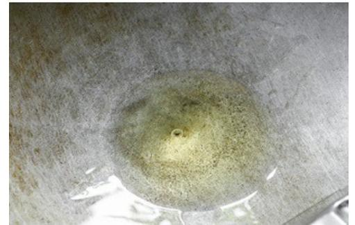
Öl am Behälterboden. Bei niedrigen Füllständen ist es sehr schwierig, Öle oder andere Flüssigkeiten exakt zu messen.
