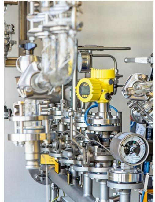
Sorgen für eine vereinfachte Qualifikation: Im Einsatz bei der CARBOGEN AMCIS AG sind zumeist standardisierte, baugleiche Druckmessumformer.
