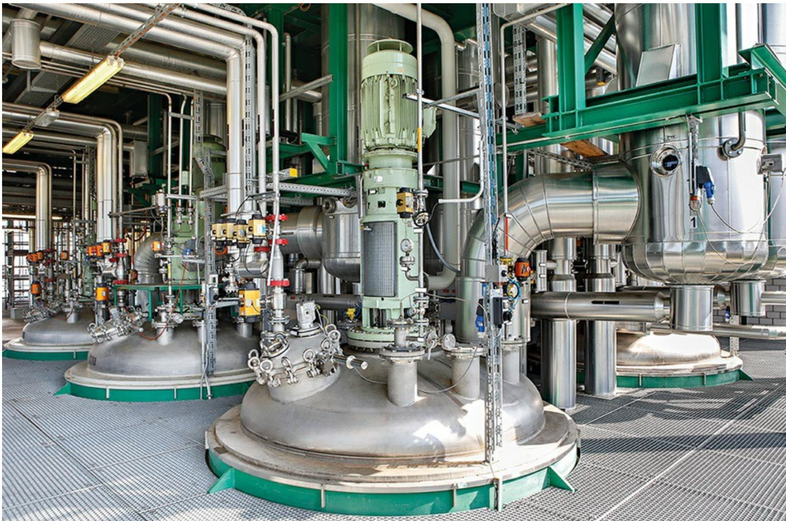
Même en présence d'agitateurs encombrants et de fortes turbulences à la surface du produit, les capteurs radar mesurent le niveau de remplissage avec précision.
