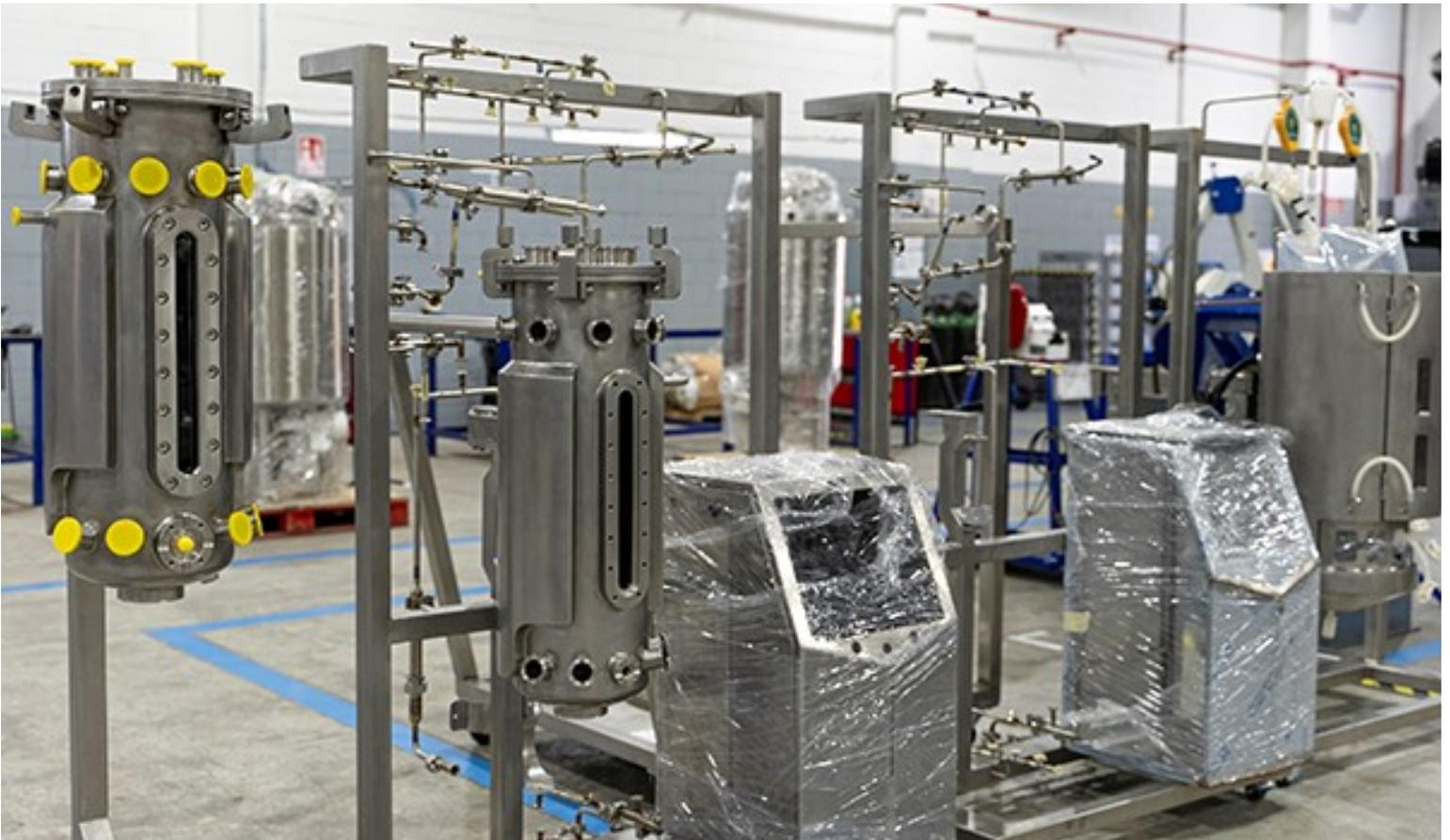
In den Anlagen werden unterschiedlichste VEGA-Sensoren eingebaut. Diese liefern wiederum ihre analogen und digitalen 4 ... 20 mA-Signale an die TECNIC-eigene eSCADA-Software. Die Software baut auf der AVEVA-Plattform auf und verwaltet die Steuerungsparameter sowie die Ausführung der Rezepte gemäß GAMP5 und CFR21. „Alle Sensoren nehmen wir selbst in Betrieb. Dabei können wir uns aber immer auf die technische Unterstützung von VEGA verlassen“, hält Manel Estany fest.
